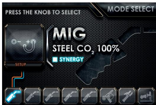
Na multifunkčním digitálním displeji se zobrazí dvě čísla. Vlevo je přednastavené svařovací napětí, vpravo je přednastavená rychlost vedení drátu. Tyto hodnoty lze nastavit otáčením pravého knoflíku (3). Díky synergickému režimu se napětí a rychlost drátu mění společně.
