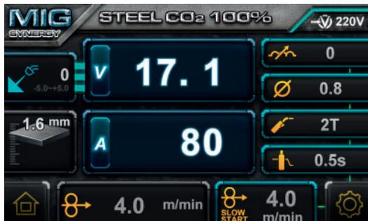
A feszültség független beállításához forgassa el a bal gombot (1)
