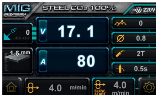
Potom pomocou ľavého gombíka (1) upravte zváracie napätie -5 ~ +5V zo štandardného synergického nastavenia. To nezmení rýchlosť drôtu. Pre ľahké použitie sa odporúča najskôr upraviť cieľovú rýchlosť posuvu drôtu a potom v prípade potreby doladiť nastavenie napätia. Odporúčané bežné nastavenia nájdete v Stručnej referenčnej tabuľke Nastavenia zvárania na strane 21 a vo vnútri dverí posuvu drôtu.
