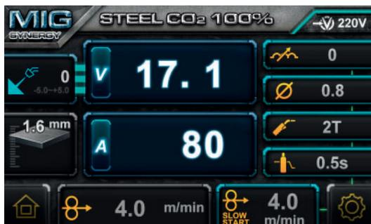
Funzione 2T / 4T: premere il pulsante destro (4), interruttore di selezione 2T / 4T per spostarsi tra le modalità 2T e 4T. Il funzionamento a 4T significa che il pulsante viene premuto una volta per avviare la saldatura e nuovamente premuto per fermarlo. Ciò è utile per i giunti di saldatura lunghi. Modalità 2T, il pulsante deve essere premuto e tenuto premuto durante la saldatura.
