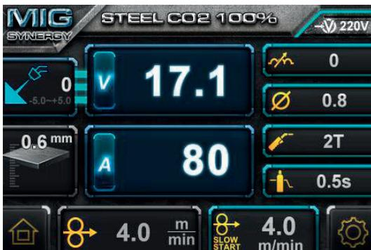
Krátka poznámka k indukčnosti - tým sa účinne upravuje intenzita zväracieho oblúka. indukčnosť robí oblúk „mäkším“ s menším rozstrekom zvaru. Vyššia indukčnosť poskytuje silnejší oblúk, ktorý môže zvýšiť prievor. Optimálne nastavenie indukčnosti ovplyvňuje veľa zväracích premenných, ako napríklad: typ materiálu, typ spoja ochranného plynu, zvärací prúd, veľkosť drôtu.
