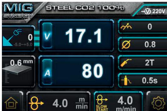
Krátká poznámka k indukčnosti - Indukcí se účinně upravuje intenzita svařovacího oblouku. indukčnost dělá oblouk "měkčím" s menším rozstříkem svaru. Vyšší indukčnost poskytuje silnější oblouk, který může zvýšit průvar. Optimální nastavení indukčnosti ovlivňuje mnoho svařovacích proměnných, jako například: typ materiálu, typ spoje ochranného plynu, svařovací proud, velikost drátu.
