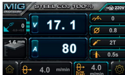
Apoi folosiți butonul stâng (1) pentru a regla tensiunea de sudare -5~+5V din setarea sinergică standard. Aceasta nu va schimba viteza firului. Se recomandă pentru o ușurință de utilizare ca mai întâi să fie reglată viteza țintă a alimentării cu fir și apoi să fie setată fin tensiunea, dacă este necesar. Consultați Diagrama de referință rapidă a Setărilor de sudare la pagina 21 și în interiorul ușii alimentării cu fir pentru a găsi setări comune recomandate.
