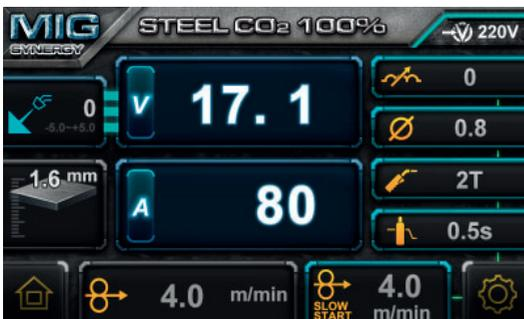
Funkce 2T / 4T: stiskněte pravé tlačítko (4), stiskem tlačítka zvolte volbu mezi režimy 2T a 4T. Provoz 4T znamená, že jedním stiskem spínače na hořáku se zahájí svařování a dalším stiskem se zastaví. To je užitečné při dlouhých svarových spojích. V režimu 2T musíte během svařování stlačit a držet spoušť.
