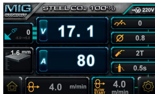
Utilizzare la manopola sinistra (1) per regolare finemente la tensione di saldatura. Avendo un controllo sinergico, questa correzione non influirà sulla velocità di avanzamento del filoscelta. Si consiglia, prima di effettuare la correzione della tensione, di selezionare la velocità del filo desiderata facendo fede, in caso di necessità, alla tabella di saldatura a pag. 12.
