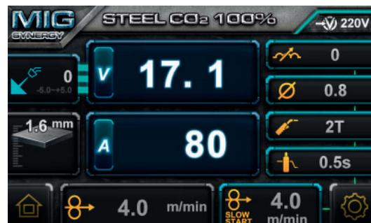
Pomocí levého knoflíku (1) upravte svařovací napětí -5 ~ +5V ze standardního synergického nastavení. Rychlost podávání drátu se nezmění. Pro snadné použití se doporučuje nejprve upravit cílovou rychlost posuvu drátu a v případě potřeby doladit nastavení napětí. Doporučené parametry naleznete ve stručné tabulce parametry svařování na straně 12 a také uvnitř dveří posuvu drátu.
