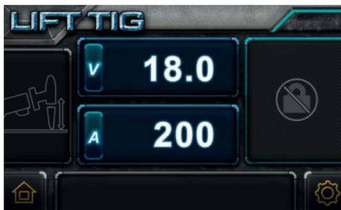
Na obrazovce se zobrazí přednastavený svařovací proud LIFT TIG. Otočením pravého knoflíku (3) je možné hodnoty upravit.
