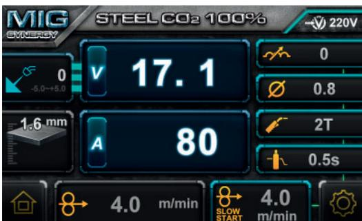
Funcția 2T/4T: apăsați butonul dreapta (4), comutatorul de selecție 2T/4T pentru a comuta între modulele 2T și 4T. Operarea 4T înseamnă că triggerul este tras o dată pentru a începe sudarea și tras din nou pentru a o opri. Acest lucru este util pentru îmbinări lungi de sudură. Modul 2T, triggerul trebuie să apăsat și menținut în timpul sudării.
