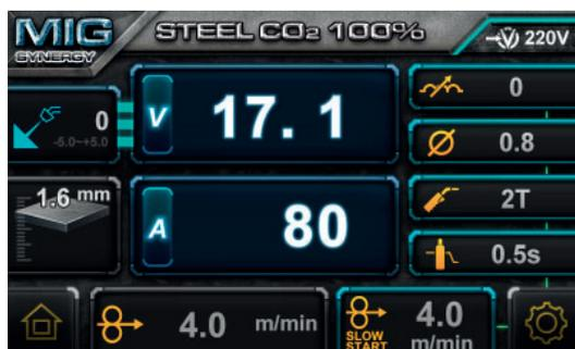
Per regolare la tensione in modo indipendente, ruotare la manopola sinistra (1) per regolare la tensione di saldatura. Questo cambierà e darà la schermata di visualizzazione come di seguito.
