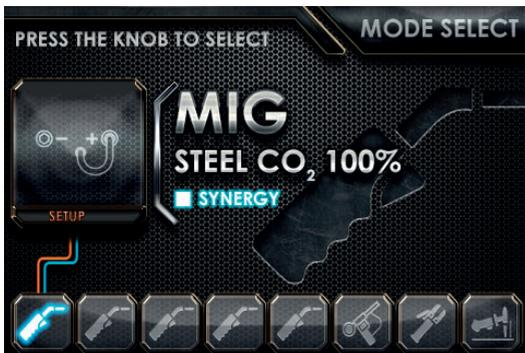
Zapnite stroj pomocou hlavného vypínača (9). Počkajte 5 sekúnd, kým sa načíta digitálny riadiaci program. Stlačením ľavého tlačidla (2) prejdite do časti režimu a vyberte režim ľavým gombíkom (1). Stlačením ľavého gombíka (1) výber potvrďte.
