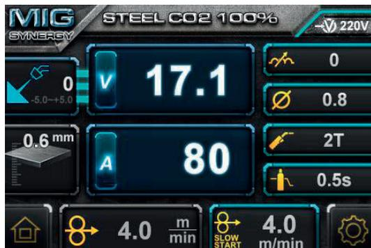
Breve nota sull'induttanza: questa regola efficacemente l'intensità dell'arco di saldatura. L'induttanza rende l'arco „più morbido”, con meno spruzzi di saldatura. Un'induttanza più elevata produce un arco più forte che può aumentare la penetrazione. Le impostazioni ottimali di induttanza sono influenzate da molte variabili di saldatura come: tipo di materiale, tipo di giunto, tipo di gas di protezione, amperaggio di saldatura, dimensione del filo.
