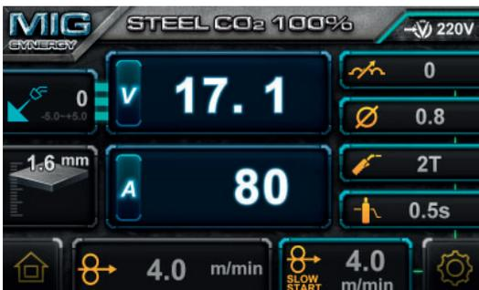
Funkcia 2T / 4T: stlačte pravé tlačidlo (4), prepínač výberu 2T / 4T na prechádzanie medzi režimami 2T a 4T. Prevádzka 4T znamená, že jedným stlačením spúšte sa zahájí zväranie a ďalším stlačením sa zastaví. To je užitočné pri dlhých zvarových spojoch. V režime 2T musí byť počas zvärania stlačená a podržaná spúšť.
